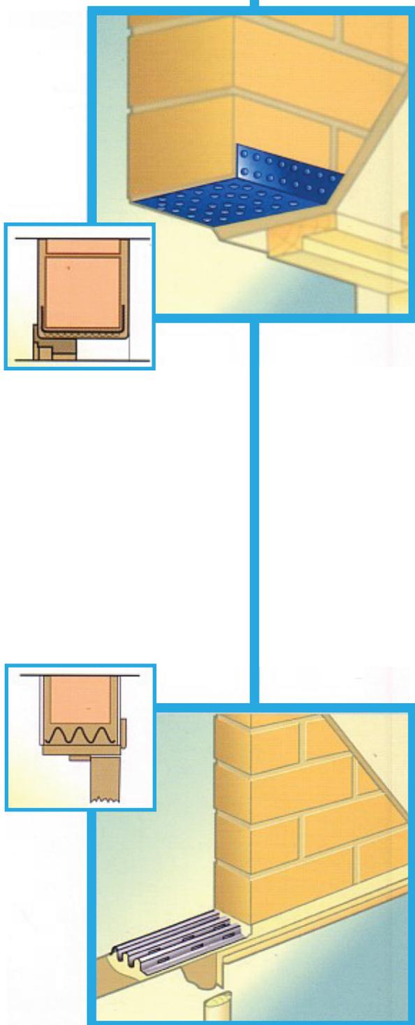
鼎达槽形钢门楣将砖墙 / 砌块墙横过门与窗的开口。由高屈服点钢而制；将表面穿孔，形成槽状，最后再加以防腐的功效。
